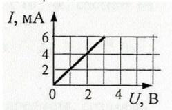
График зависимости силы тока в проводнике от напряжения между его концами
